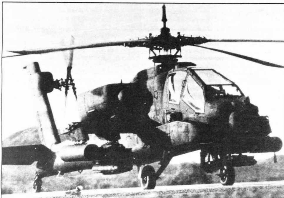
Śmigłowce AH-64A dostarczano do US Army pokryte specjalną farbą ciemnozieloną, częściowo pochłaniającą promieniowanie radarowe ● AH-64A were delivered to the US Army painted in a Flat Dark Green camouflage scheme. The paint is a special type, designed to partially absorb radar signals Zdjęcie: Teledyne Ryan
