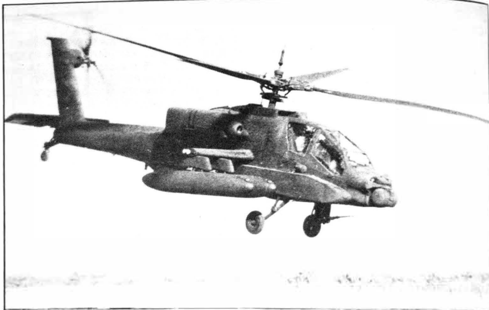
AH-64A Apache w konfiguracji do przebazowania, ze zbiornikami dodatkowymi wykonanymi z kewlaru ● The AH-64A prepared for long-range flight, with underwing fuel tanks made of kevlar
