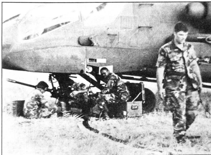
Zaladunek amunicji do działka, przez obsługę naziemną, przy użyciu specjalnego urządzenia ● Ground crewmen load ammunition into the magazine of AH-64A's gun, using the uploading adapter Zdjęcie: Western Design
