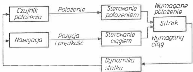
7. Uproszczony schemat blokowy układu sterująco-nawigacyjnego statku
