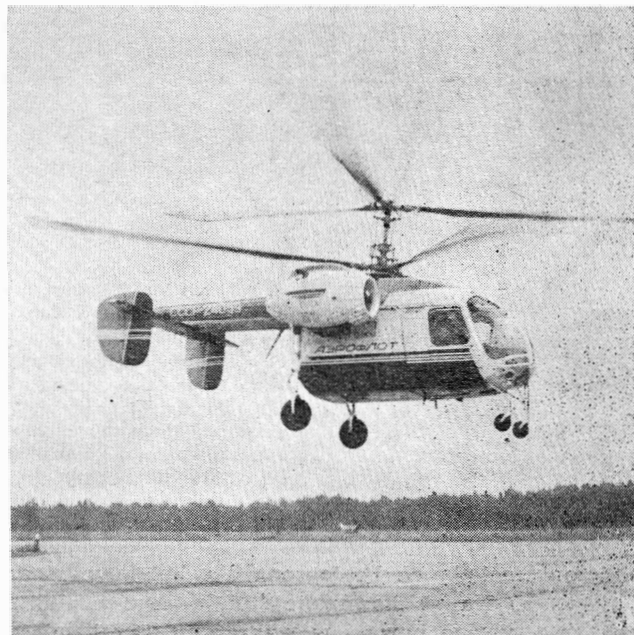
1. Śmigłowca Ka-26 — typowy przedstawiciel układu współosiowego
