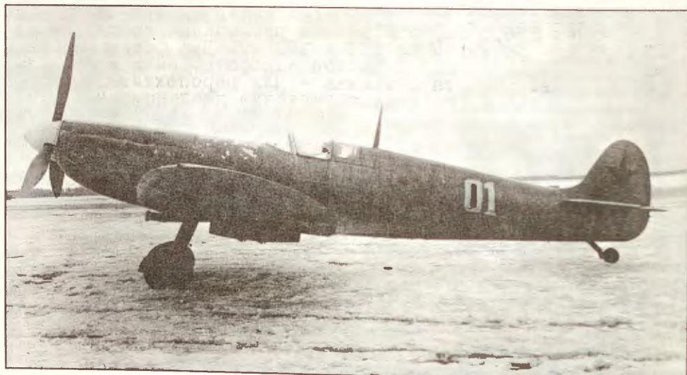
Supermarine Spitfire Mk. Vb w odmianie rozpoznawczej, podczas badań w NII WWS
