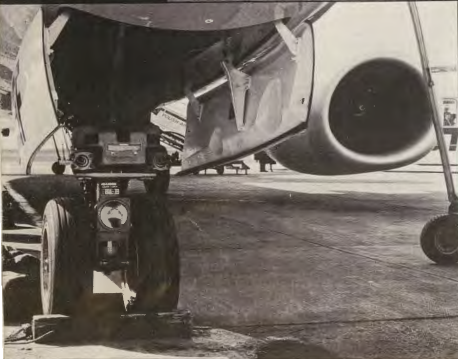
▲ Podwozie przednie w widoku z przodu ► Kabina pilotów. Widać m.in. konsolę środkową (z przyrządami sterowania systemów EHSI i EFIS) oraz przyrządy sufitowe, niewidoczne na zdjęciu barwnym na poprzedniej stronie
