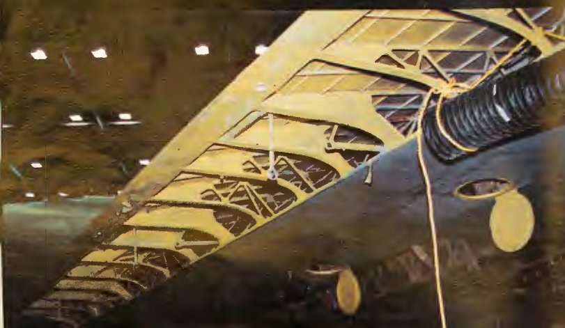
◀ Wnętrze przedniej części kadłuba - widok ku kabynie pilotów ▼ Splywowa część lewego skrzydła od dołu, po zdjęciu klap
