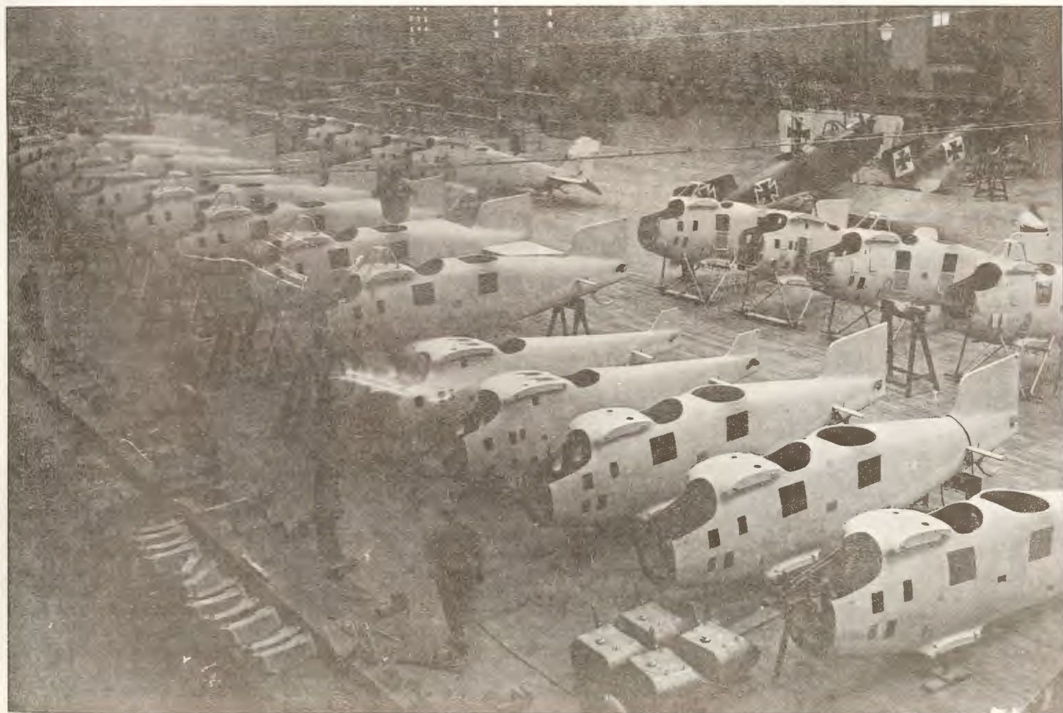
▲ Wodnopłatowiec LFG Roland WD (silnik Daimler D.III 118 kW, tj. 160 KM) z numerem (jeszcze nie namalowanym) M/N 750, przed fabryką
