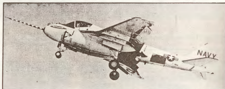
Pierwszy prototyp A-6A – widoczne dyższe silników odchylone ku dołowi
