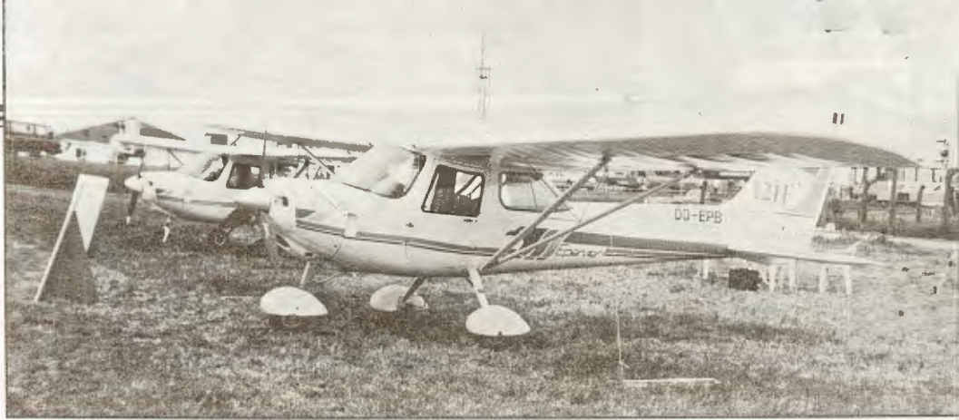
Kompozytowy belgijski mikrosamolot Epervier
