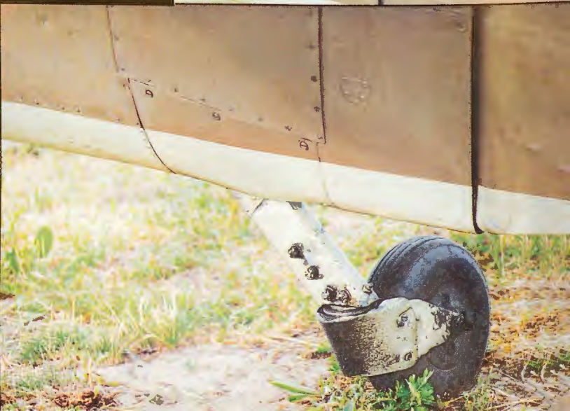
▲ Prawa strona usterzenia – na sterze kierunku widoczna osłona popychacza klapki wyważającej (tylko z prawej strony) oraz tylne światło nawigacyjne; na usterzeniu poziomym dobrze widoczny obrys osłony popychacza klapki wyważającej oraz profil części noskowej ► Kółko ogonowe (skrecone o ok. 90°) Zdjęcia: Ryszard Jaxa-Malachowski (4) Wojtek Matusiak (11)
