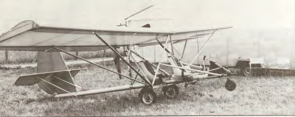
ULM SkyWalker (powietrzny spacerowicz) – reklamowany również dla celów rolniczych; ma też wersję pływakową i na nartach. Z prawej – zbliżenie zastrzału SkyWalkera i widoczne listwy-turbulizatory do zmniejszenia oderwania strug
