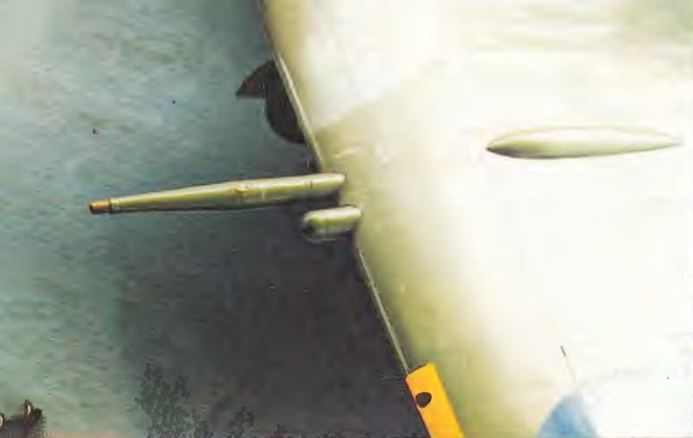
▲ Działko British Hispano kal. 20 mm w skrzydle typu C. Obok – osłonięty owiewką – wylot w miejscu przewidzianym na drugie działko. Poniżej – wylot lufy k.m. Colt Browning kal. 7,7 mm. W warunkach bojowych otwór ten zaklejało przed lotem ▲ ► Rurka Pitota pod lewym skrzydłem (z osłoną zakładaną na ziemi)
