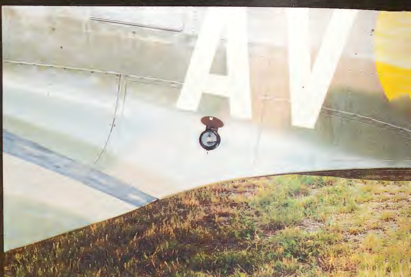
► Wyprowadzenie popychacza napędu steru kierunku z kadłuba i okucie mocowane do dźwigu steru; powyżej – otwór w stateczniku pionowym, przez który przechodzi dźwigar steru wysokości
