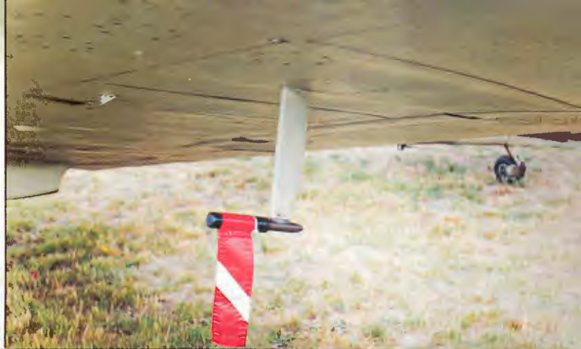
▲ Działko British Hispano kal. 20 mm w skrzydle typu C. Obok – osłonięty owiewką – wylot w miejscu przewidzianym na drugie działko. Poniżej – wylot lufy k.m. Colt Browning kal. 7,7 mm. W warunkach bojowych otwór ten zaklejało przed lotem ▲ ► Rurka Pitota pod lewym skrzydłem (z osłoną zakładaną na ziemi)
