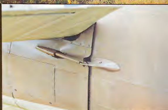
► Wyprowadzenie popychacza napędu steru kierunku z kadłuba i okucie mocowane do dźwigu steru; powyżej – otwór w stateczniku pionowym, przez który przechodzi dźwigar steru wysokości
