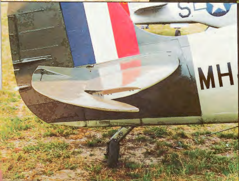
▲ Prawa strona usterzenia – na sterze kierunku widoczna osłona popychacza klapki wyważającej (tylko z prawej strony) oraz tylne światło nawigacyjne; na usterzeniu poziomym dobrze widoczny obrys osłony popychacza klapki wyważającej oraz profil części noskowej ► Kółko ogonowe (skrecone o ok. 90°) Zdjęcia: Ryszard Jaxa-Malachowski (4) Wojtek Matusiak (11)
