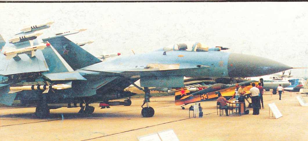
◀ Smigłowiec myśliwsko-szturmowy Kamow Ka-50 (Hokum) ▶ Zewnętrzna, złożona część lewego skrzydła Su-27K, z podwieszonym uzbrojeniem ▶ Sposób składania skrzydła Su-27K - brak masywnych okuc w miejscach łamania dźwigarów, zasadnicze obciążenia są przenoszone ciągłym układem zawiasów wzdłuż pokrycia ▶ Dobrze widoczne składane usterzenie poziome Su-27K ▼ Pokładowy samolot myśliwski Suchoj Su-27K
