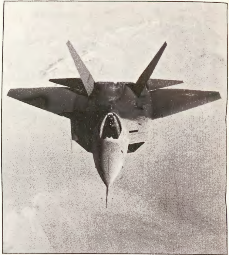
– A dokąd to, dokąd to, dokąd tak gna... (prototyp następcy F-15 Eagle'a, Lockheed-Boeing-General Dynamics – obecnie już tylko Lockheed-Boeing – F-22 Lightning II; opisaliśmy go w „AERO-TL” nr 3/91) Fot. Boeing D & SG
