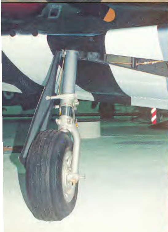
▲ Szczegóły podwozia głównego samolotu P-51D s/n 44-63871 – eksponatu Musée de l’Air w Paryżu Zdjęcie: Piotr Górski ▶ ▲ Podwozie główne P-51D z RAF Museum w Hendon Zdjęcia: Wojciech J. Gawrych ▼ P-51D w barwach samolotu Capt. Chucka Yaegera – s/n 44-14888 B6-Y „Glamorous Glen III” Zdjęcie: Richard Palimąka
