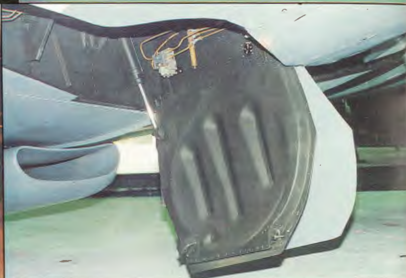
▲ Szczegóły podwozia głównego samolotu P-51D s/n 44-63871 – eksponatu Musée de l’Air w Paryżu Zdjęcie: Piotr Górski ▶ ▲ Podwozie główne P-51D z RAF Museum w Hendon Zdjęcia: Wojciech J. Gawrych ▼ P-51D w barwach samolotu Capt. Chucka Yaegera – s/n 44-14888 B6-Y „Glamorous Glen III” Zdjęcie: Richard Palimąka
