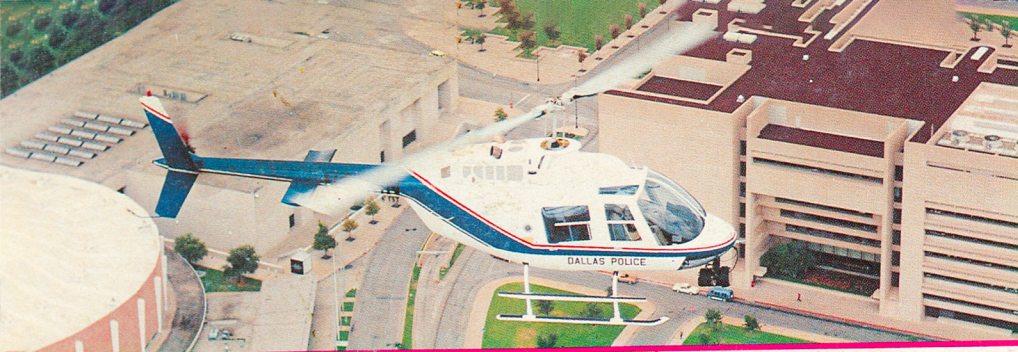
Bell 206B Jet Ranger III Policji w Dallas (USA). Dodatkowy reflektor z przodu u dołu oraz dodatkowy stopień na płozie
