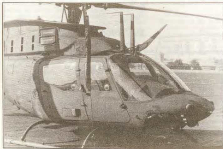
OH-58D nr 88-0287 z 5. Batalionu 158. Regimentu US Army. Widoczne ostrza do przecinania drutów i anteny systemu łączności
