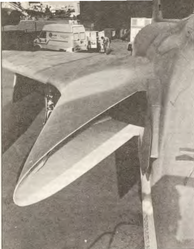
▲ Podskrzydłowy zbiornik paliwa o poj. 1703 l (750 US Gal.)
