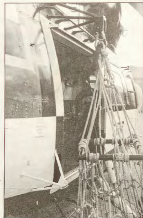
Siatki ratownicze do transportu 4 osób na zewnątrz śmigłowca PZL W-3 Sokół Straży Pożarnej (polska wytwórnia wciąż używa rosyjskiego oznaczenia śmigłowca W-3 – od wiertłot trietij)
