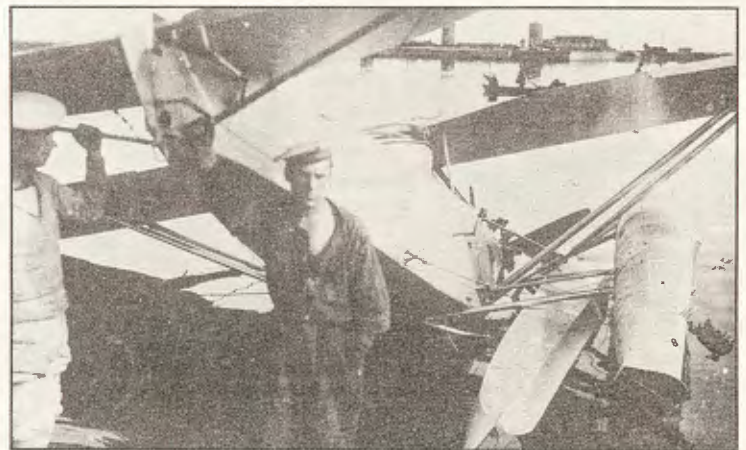
R-XIIIbis/hydro nr 701 po wypadku 8 czerwca 1933 r. w Pińsku. Ze zdjęcia wynika, że samolot (wodnopłatowiec) miał metalowe pływaki typu Puck. Drewniane pływaki (typu Pińsk) zdjęto prawdopodobnie po wcześniejszym uszkodzeniu
