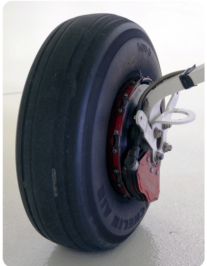
Szczegół hamulca na kole podwozia głównego
