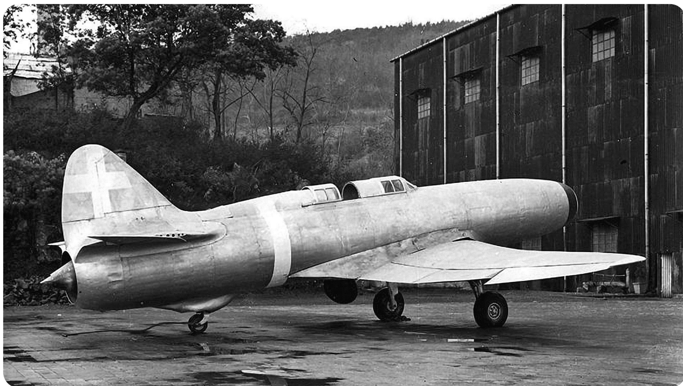
Ryc. 6. Ukończony egzemplarz C.C.2 na terenie zakładów Caproni w Taliedo. Dobrze widoczny stożek regulacji siły ciągu Źródło: [14]
