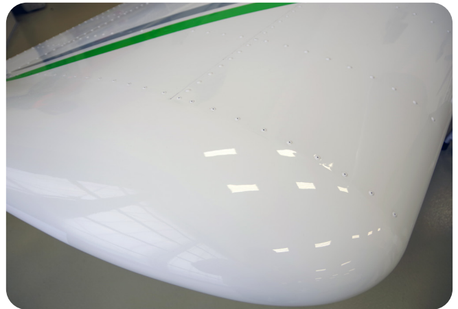
Winglet na lewym skrzydle, krawędź natarcia
