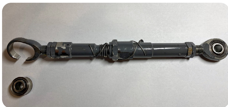
Ryc. 8. Popychacz po próbie jednoosiowego rozciągania. Fot. S. Baryły
