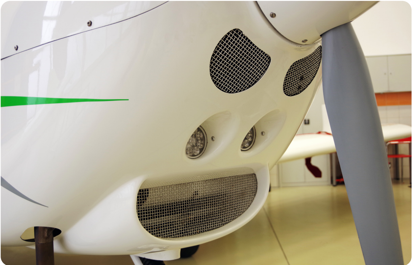
Wlot powietrza do chłodnicy silnika
