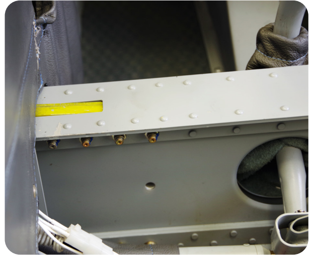
Dźwigar główny, widok z tyłu po zdjęciu foteli
