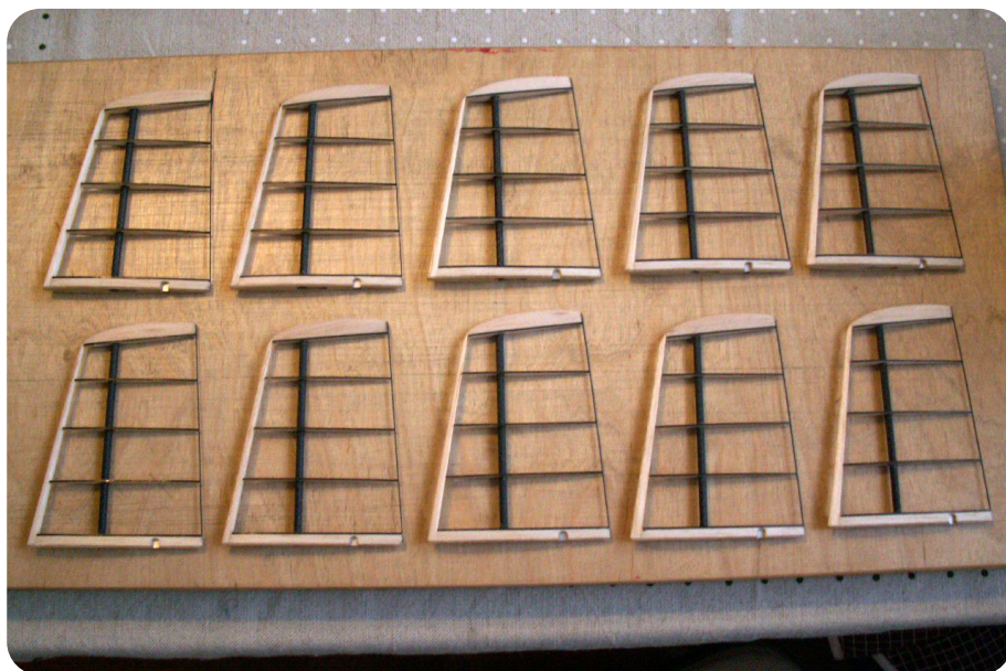
Ryc. 1. Szkieletowa konstrukcja statecznika pionowego, wykonana częściowo z balsy i włókna węglowego Fot. J. Cihak
