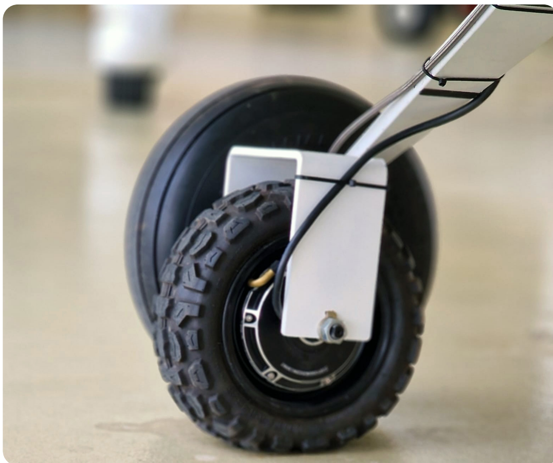
Ryc. 2. Prototypowe rozwiązanie podwozia samolotu na podstawie wynalazku
