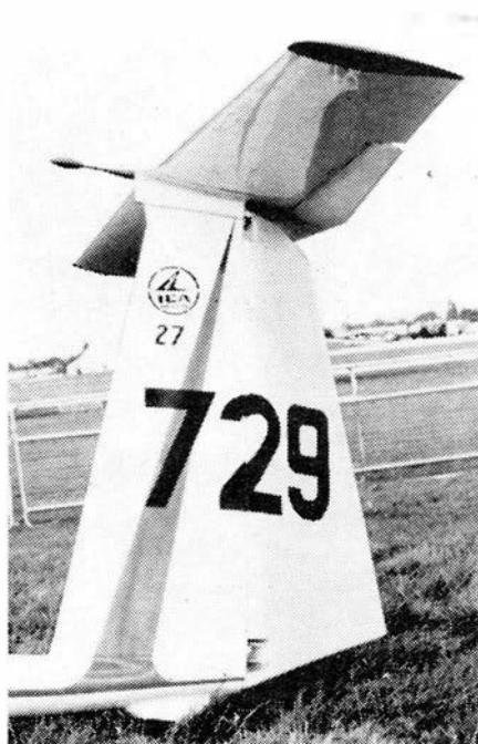
Płytowe usterzenie z przeciwcieżarem
