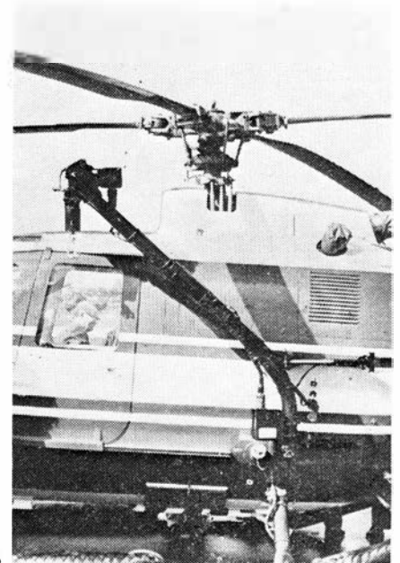
13. Urządzenie dźwigowe na śmigłowcu Bolkow Bo-105 Fot. A. Glass ▲
