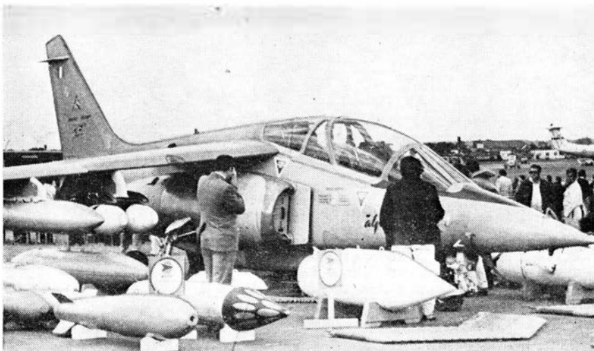
11. Treningowo-szturmowy Alpha Jet i różne wersje jego uzbrojenia Fot. A. Glass
