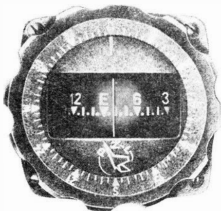
Rys. 5. Szybowcowa busola magnetyczna BS-1. Magnetic Compass BS-1
