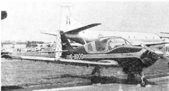
Rys. 2. Brytyjski Bullfinch — odmiana Bulldoga z chowanym podwoziem. Fot. A. Glass
