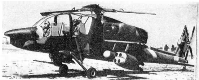
Rys. 2. Makieta śmigłowca Hughes YAH-64 z zasobnikami dla 8 pocisków TOW i dwiema bombami. W części dziobowej widoczny jest wylot działka konstrukcji Hughes'a chain-gun
