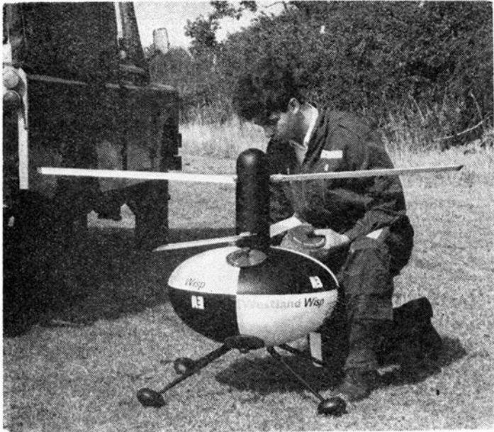
Rys. 20. Wywiadowczy bezpilotowy miniaturowy śmigłowiec brytyjski Westland A3 Wisp napędzany silnikiem tłokowym
