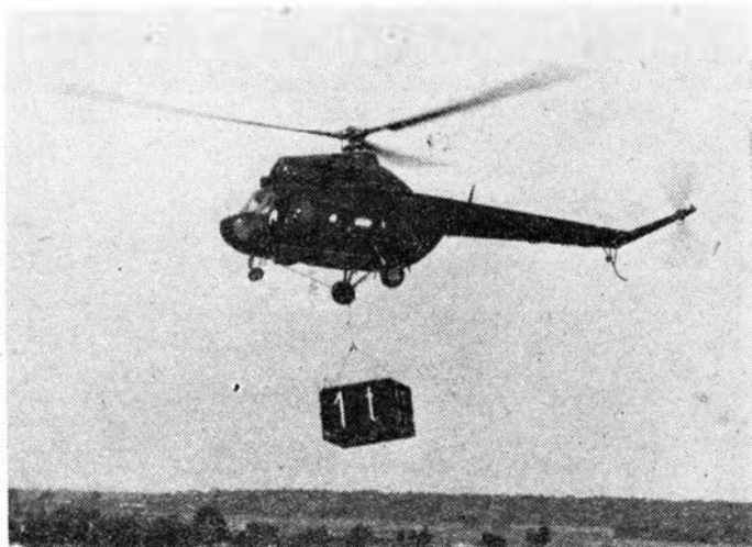
Rys. 2. Mi-2 dźwigowy z ładunkiem 1000 kg. Mi-2 with 1000 kg external cargo
