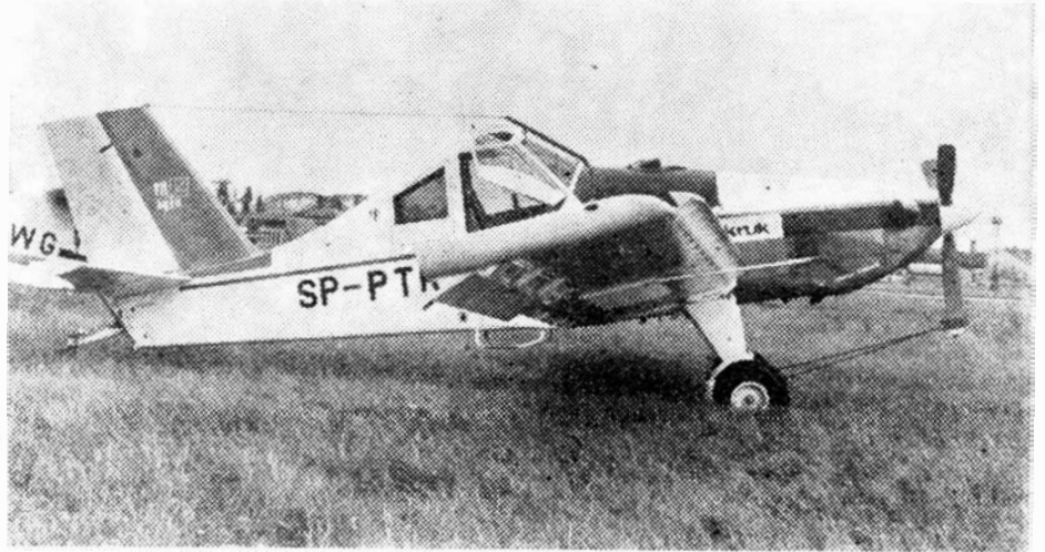
Prototyp samolotu rolniczego PZL-106AT Turbo Kruk (SP-PTK) z silnikiem PT6A-34AG wykonał pierwszy lot 22.06.1981 r. Fot. W. Garbarczyk
