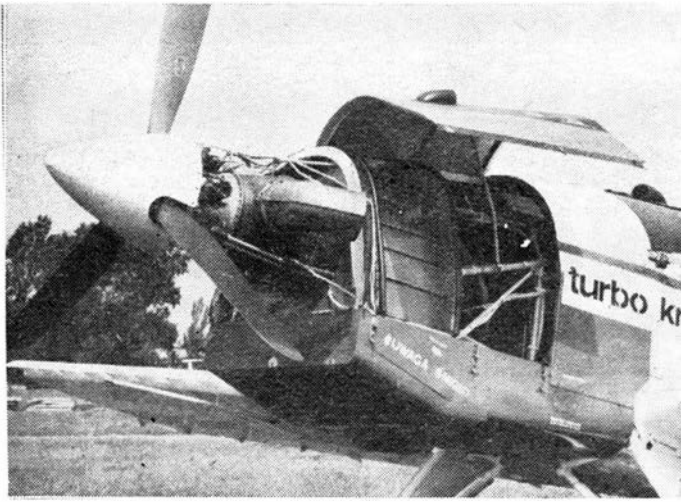
Rys. 8. Zespół napędowy Turbo Kruka/The power plant of the PZL-106AT Turbo Kruk. Fot. WPL
