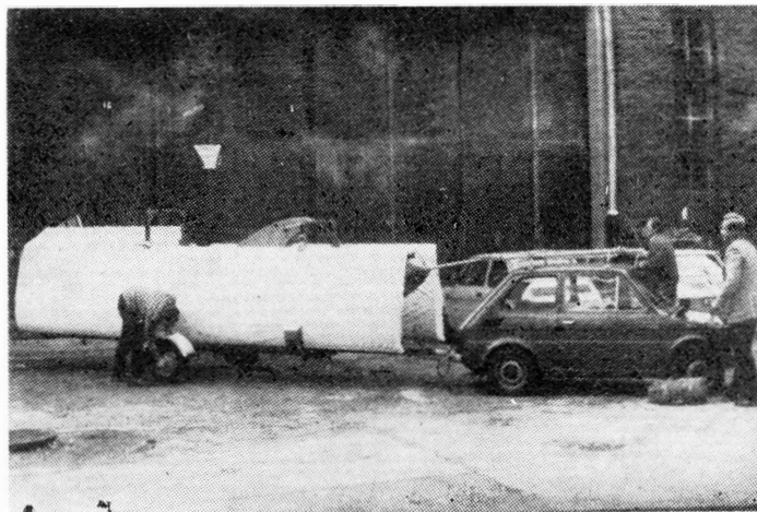
Rys. 6. Do transportu szybowca zastosowano zmodyfikowany wózek transportowy do łodzi i samochód Fiat 126p
