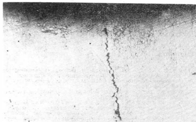
8. Siatka mikropeknięć na głębokości 0,5 mm od powierzchni łopatki. Szlif nietrawiony. Pow. 200 X
