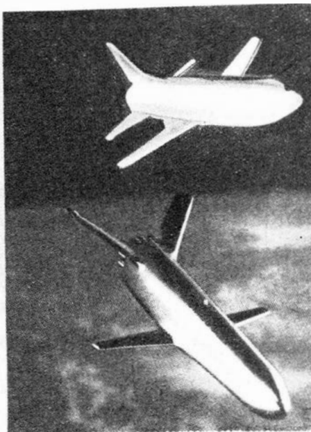
4. Firma North American Rockwell zaprojektowała rakietę transportową w dwóch wersjach. W pierwszej, stopień orbitalny wyposażony jest w skrzydła w kształcie delta, w drugiej (rysunek z prawej) stopień startowy ma proste skrzydła. W obu wersjach stopień startowy ma proste skrzydła
