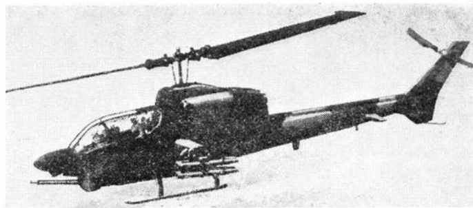
Rys. 4. Śmigłowiec szturmowy AH-1S, wyposażony w osiem przewodowo kierowanych pocisków TOW
