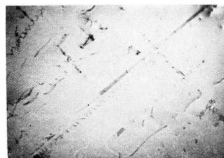
Rys. 9. Struktura stopu EJ437B. Roztwór stały na osnowie niklu. Próbkę nr 18. Pow. 27400 X
