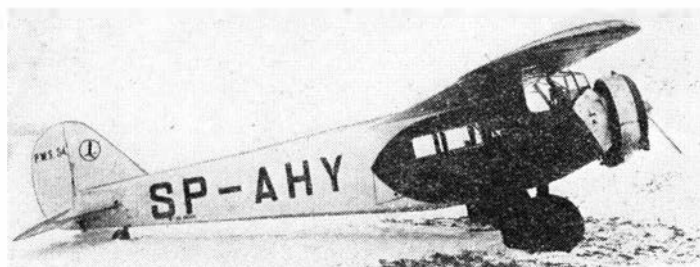
Rys. 8. Szybki pocztowy PWS-54 (1933 r.) o zbyt małym zasięgu
