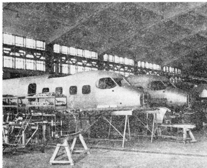
Rys. 3. Kadłuby pierwszych samolotów An-28/Fuselages of the first batch of An-28s
