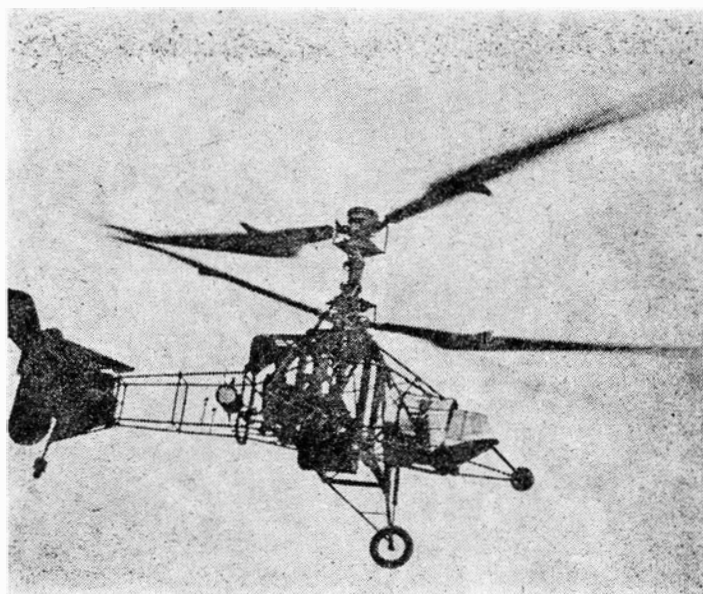
Rys. 3. Śmigłowiec Breguet-Dorand Gyroplane w drugim wariantie konstrukcyjnym z 1935 r.
