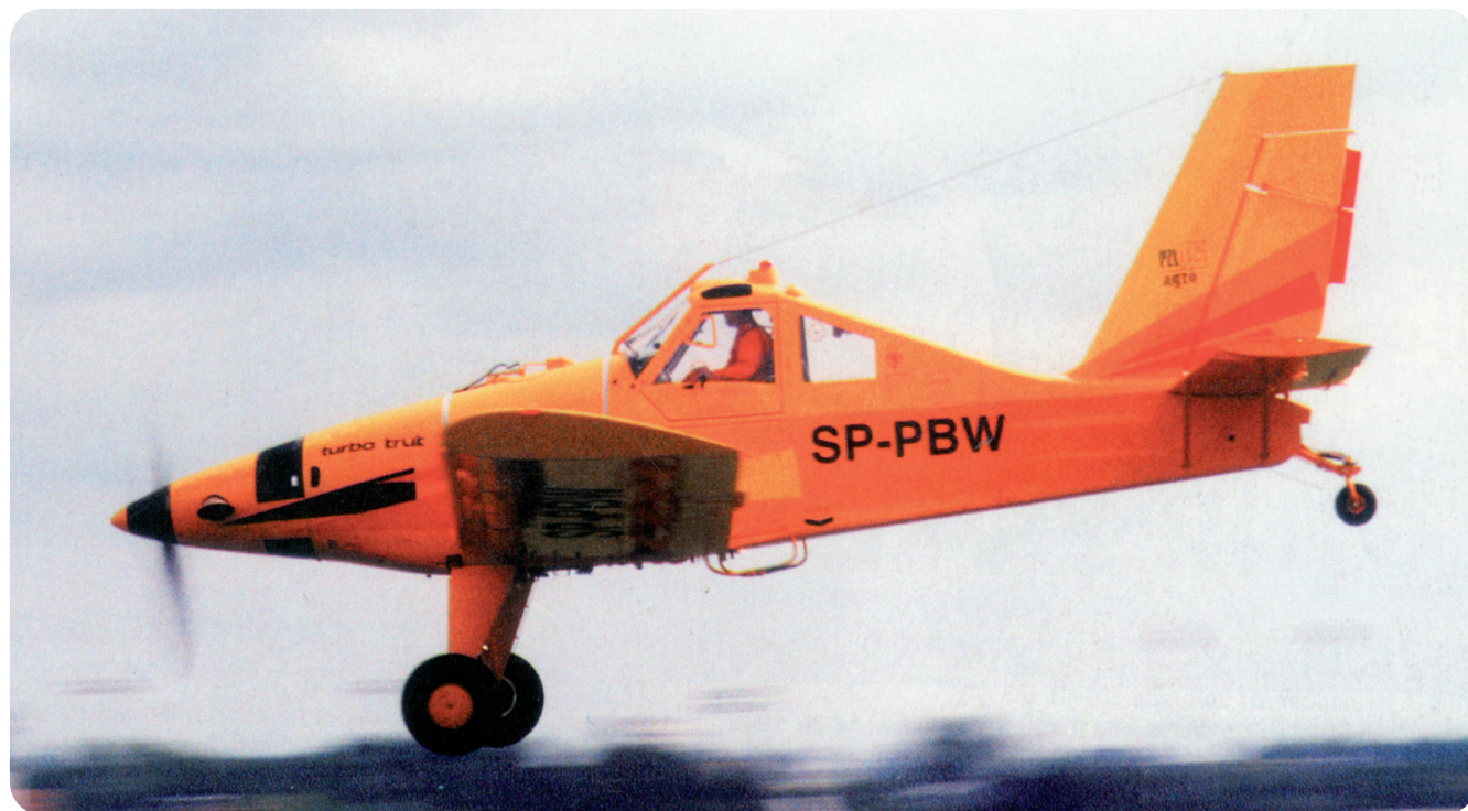
Ryc. 8. Kruk BTU SP-PBW podczas oblotu 18 sierpnia 1998 r. z amerykańskim silnikiem turbośmigłowym PW PT-6A34 AG
