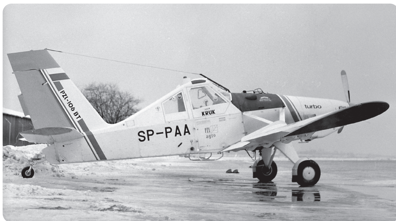
Ryc. 5. PZL-106 BT Kruk SP-PAA z czeskim silnikiem turbośmigłowym M-601 z 1985 r. na Okęciu w trakcie prób fabrycznych
