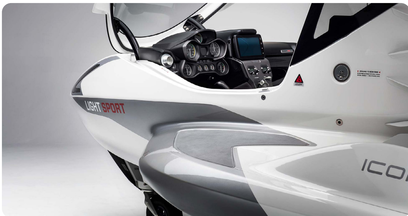
Ryc. 16. Dodatkowe powierzchnie aerodynamiczne Seawings
