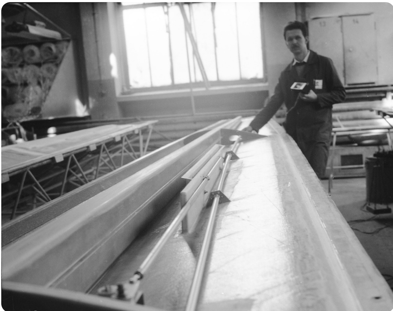
Ryc. 16. Mgr inż. Stanisław Zientek – główny konstruktor szybowca – przy foremniku dolnej skorupy skrzydła (widoczny wklejony dźwigar, szkielet skrzydła z napędami, skrzynka hamulca aerodynamicznego)
