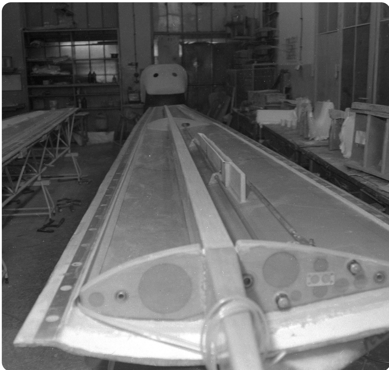
Ryc. 22. Skrzydło w budowie
