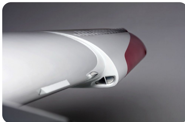
Ryc. 9. Fragment skrzydła ICON A5 z widocznym zastosowanym mankietem
