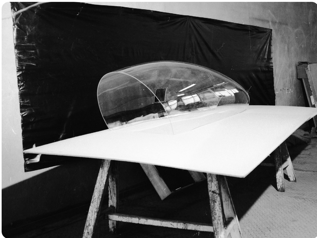
Ryc. 24. Szyba limuzyny przed wklejeniem w ramę – pleksi o grubości 4 mm
