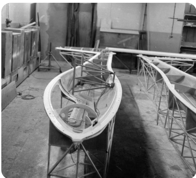
Ryc. 17. Kadłub „Juniora” w budowie (w foremnikach) – widoczna wklejona kratownica i inne wewnętrzne elementy kadłuba
