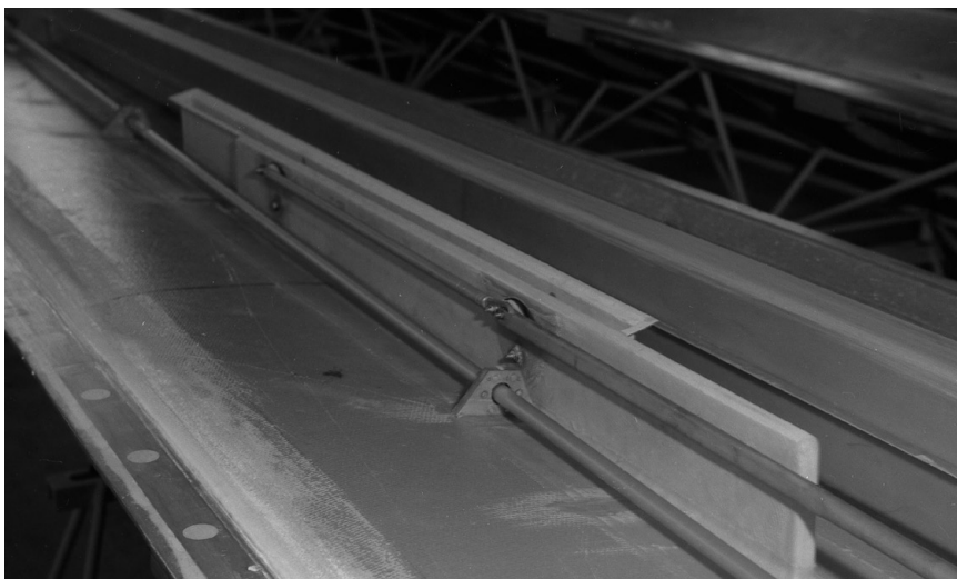
Ryc. 21. Wklejona do skorupy dolnej skrzynka hamulca aerodynamicznego, widoczny też popychacz napędu lotki i hamulca Źródło: Archiwum SZD
