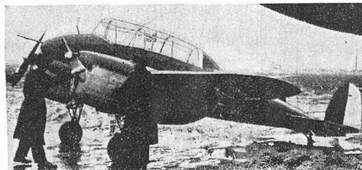
Rys. 7. Drugi prototyp Wyżeła w próbach w ITL w marcu 1939 r. Podwozie zmodyfikowane
