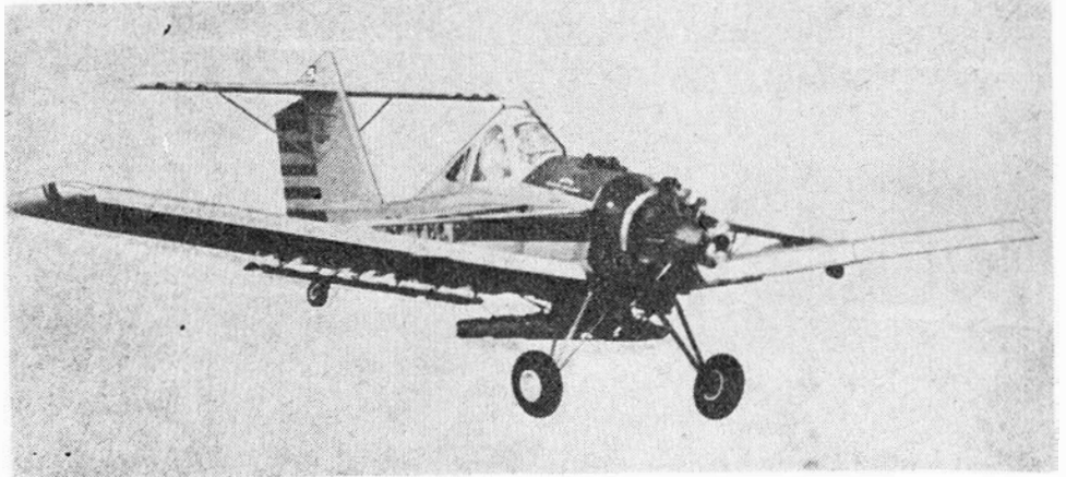
Prototyp nr 5 samolotu PZL-106 Kruk, o powiększonej rozpiętości, napędzany silnikiem PZL-35 600 KM
