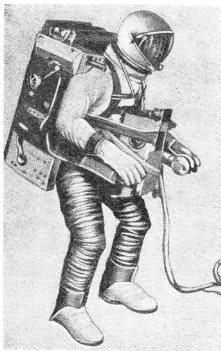
Rys. 1. Astronauta z plecowym urządzeniem napędowo-klimatyzacyjnym. Na piersiach znajduje się regulator działania tego urządzenia
