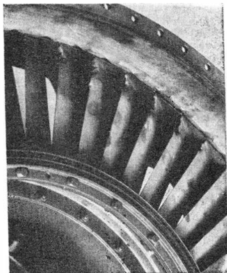
Rys. 9. Uszkodzenie łopatek kierownicy turbiny przez zassaną do silnika śrubę
