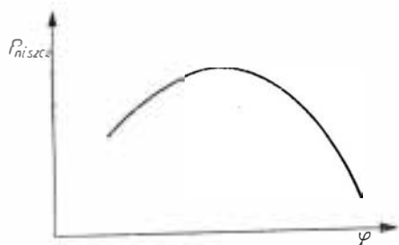
Rys. 4. Zależność ciśnienia niszczonego od kąta nawinięcia szklanych włókien zbrojenia
