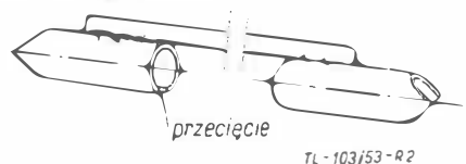
Rys. 2 — Szablon do wykonania zakończeń rur
