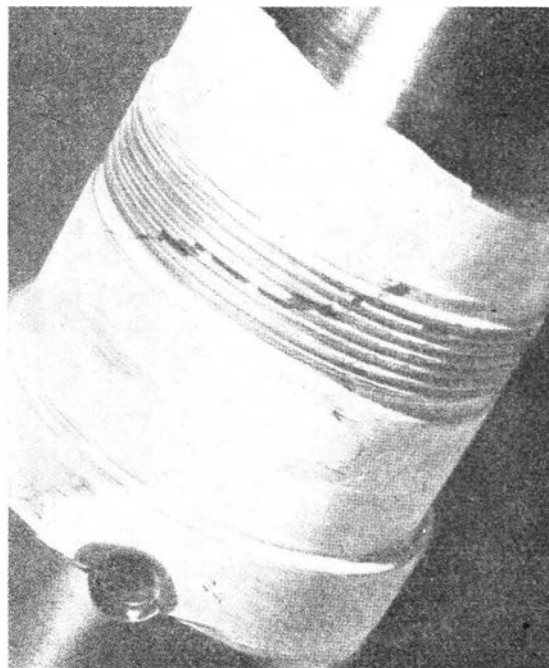
Rys. 2. Fotografia czopa wału korbowego z uwidocznionym pęknięciem przechodzącym przez zwoje gwintu.
