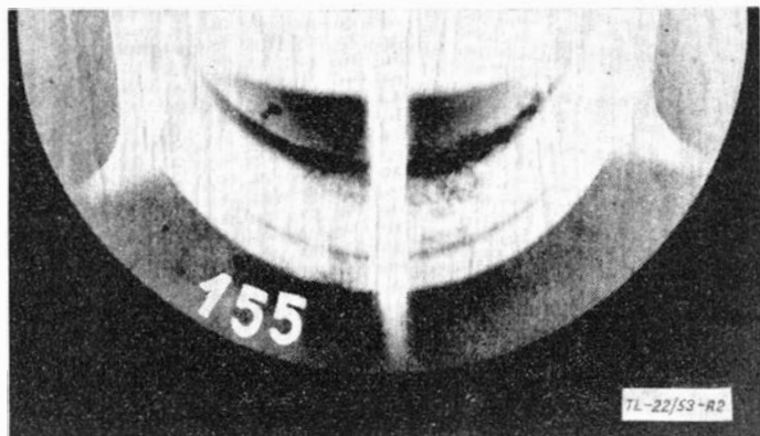
Rys. 2. Rentgenogram (negatyw) odlewu aluminiowego. Widoczne jamy, pęcherze i porowatość odlewu.
