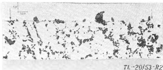
Rys. 2 — Wytrzymałość zwarcia większa niż metalu powierzchni trącej powoduje wyrwanie cząstek jednej powierzchni i przywarcie ich do drugiej. Cząstki miedzi przywarły do powierzchni stali po jednokrotnym przesunięciu miedzi po stali.
