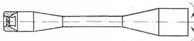
Rys. 13 — Silnik pulsacyjny z rozszerzonym wylotem TL-50/53-R13
