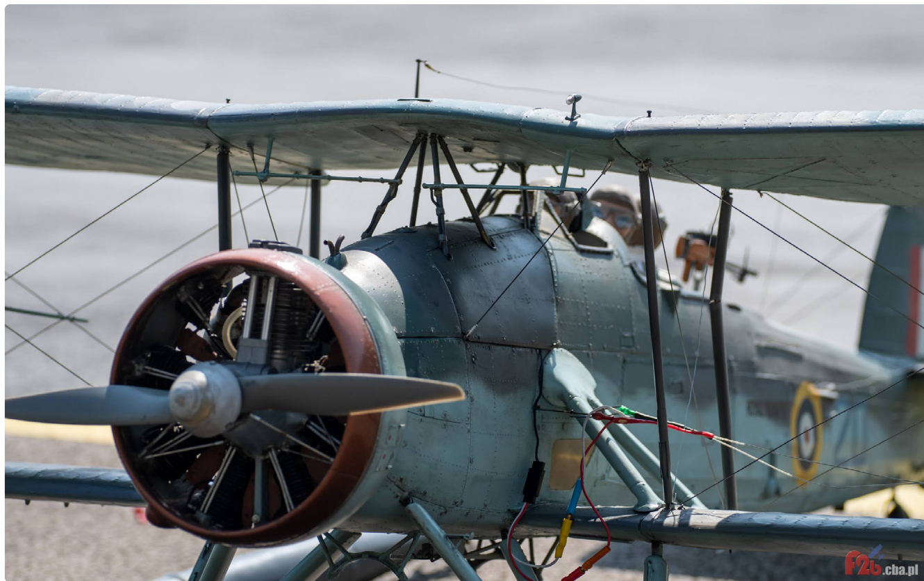
Ryc. 1. Widok z przodu modelu: makieta silnika, stójka górnego płata, cięgna wykrzyżowania
