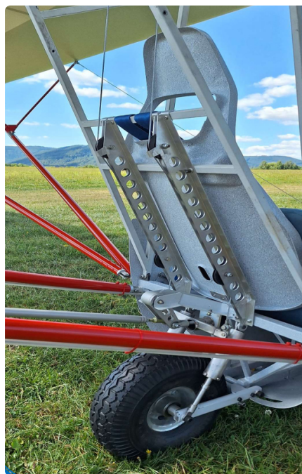
Ryc. 7. Szczegóły podwozia oraz przeniesienia napędu lotek
