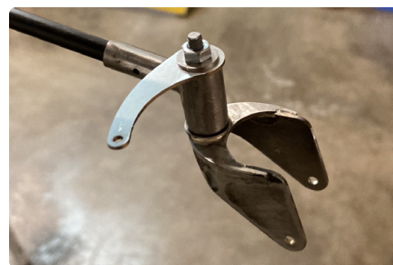
Ryc. 24. Okucie koła ogonowego wraz z ostrogą
