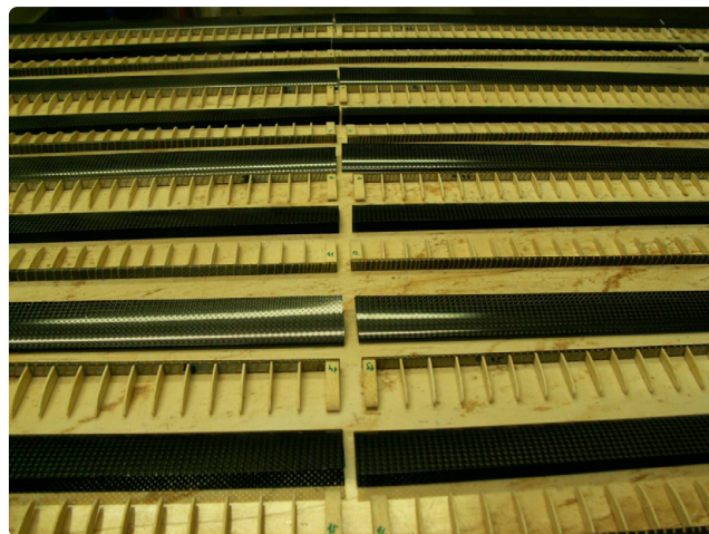
Ryc. 6. D-boxy przygotowane do klejenia
