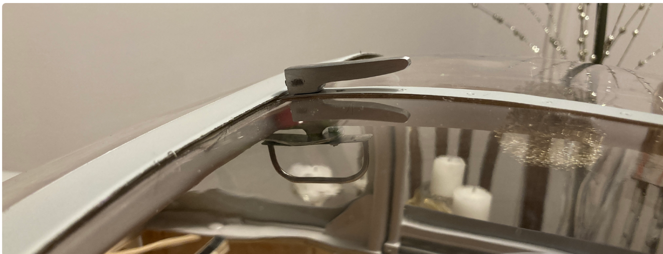
Ryc. 30. Zamek w górnej części osłony kabiny nie jest funkcjonalny, ma na celu jedynie odtworzenie szczegółu jak w oryginalnym samolocie
