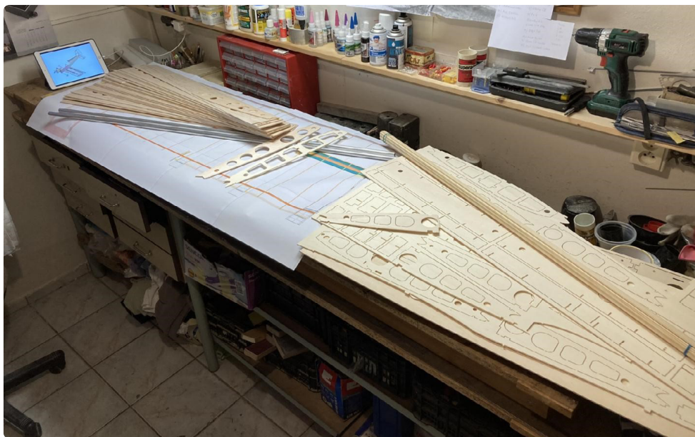
Ryc. 3. Wyfrezowane części gotowe do budowy skrzydeł
