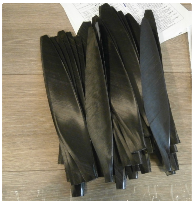
Ryc. 12. Łopaty śmigieł modelu z napędem gumowym klasy F1B, wykonane z kompozytu karbonowo-epoksydowego
