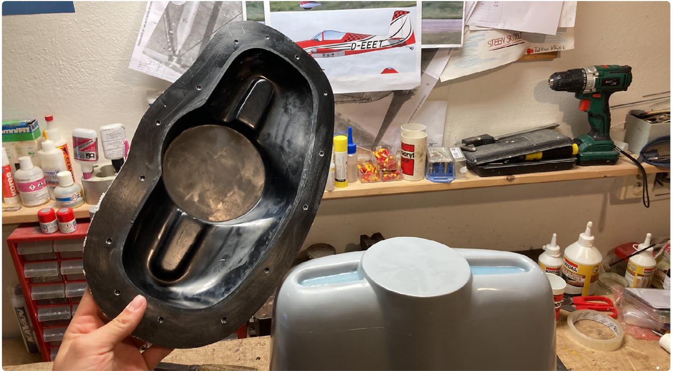
Ryc. 18. Surowa forma negatywowa osłony silnika po zdjęciu z kopyta
