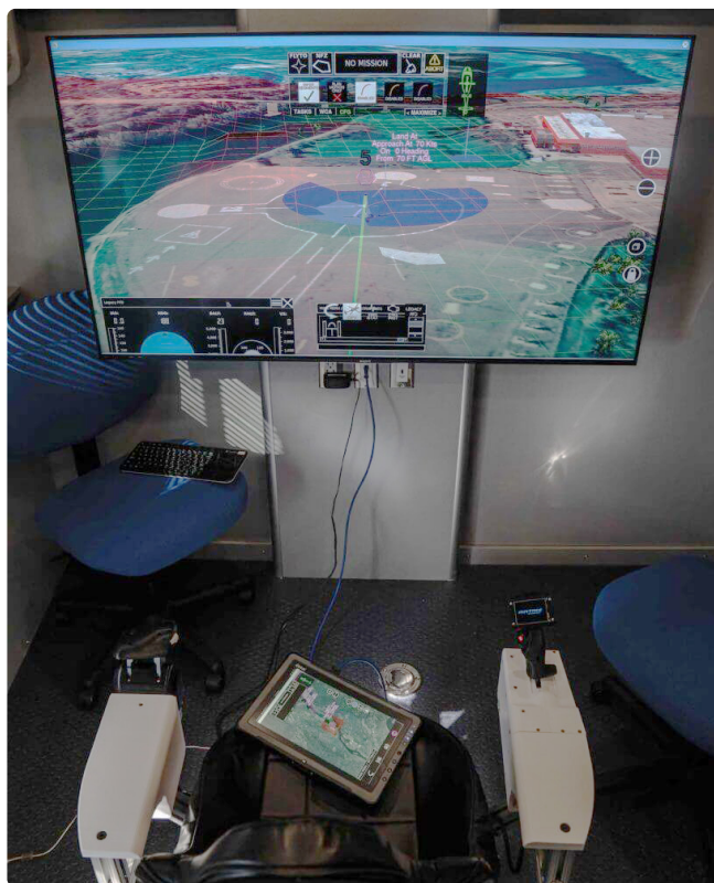
Ryc. 3. Symulator SARA pozwalający na monitorowanie oraz zdalne sterowanie śmigłowcem. Źródło: [2]
