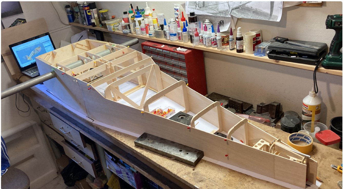
Ryc. 11. Kadłub w trakcie montażu
