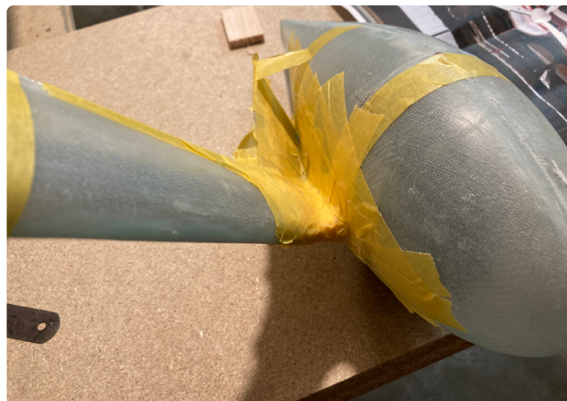
Ryc. 23. Wykonanie opprofilowania przejścia między rękawem goleni podwozia a osłoną koła
