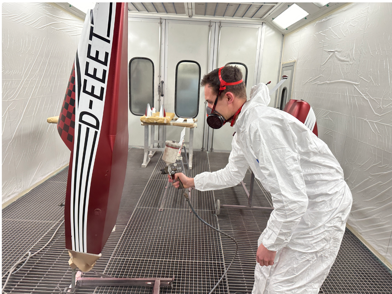
Ryc. 35. Malowanie natryskowe modelu w komorze lakierniczej
