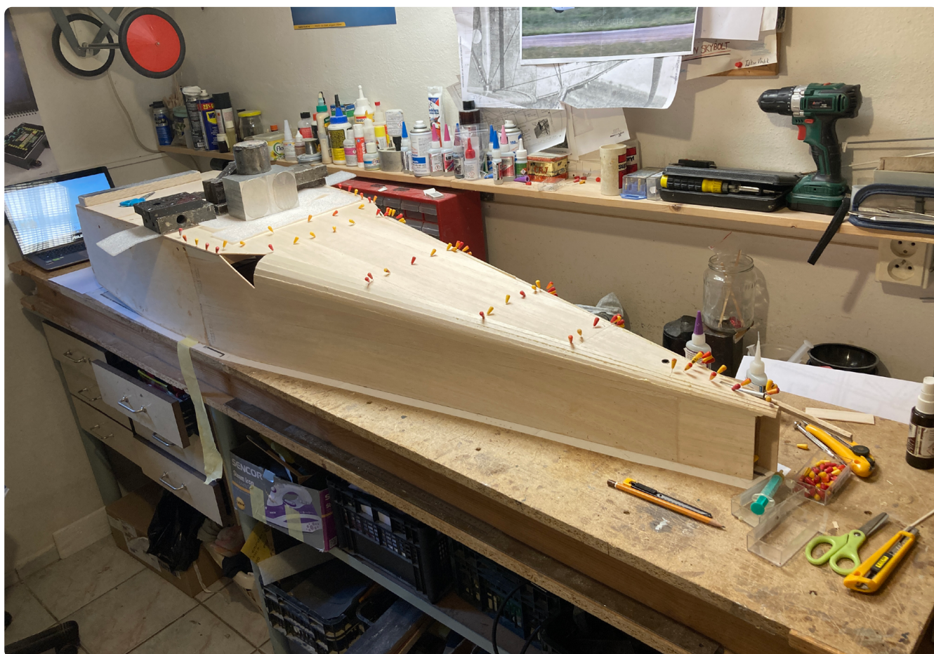
Ryc. 13. Klejenie poszycia kadłuba
