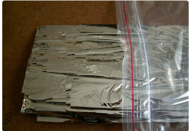
Ryc. 10. Materiał pokryciowy Mylar
