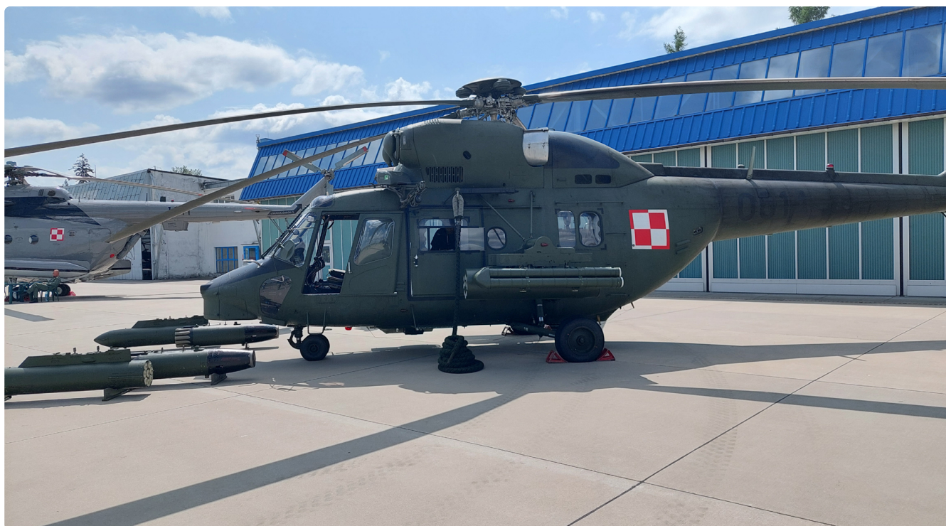
Ryc. 2. Śmigłowiec PZL SW 3 SOKÓŁ, widoczne są także alternatywne podwieszenia uzbrojenia. Fot. Jarosław Mądro
