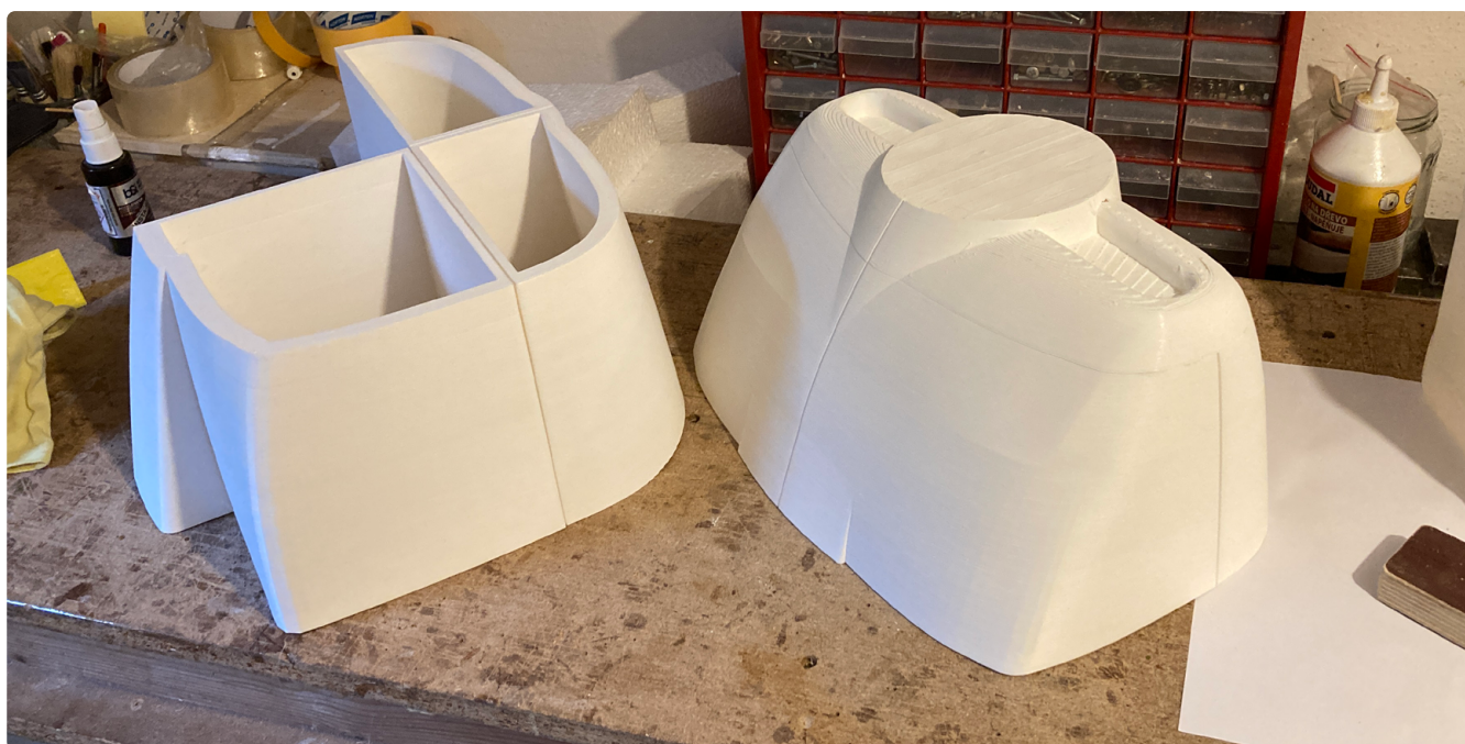
Ryc. 17. Budowa formy pozytywowej osłony silnika
