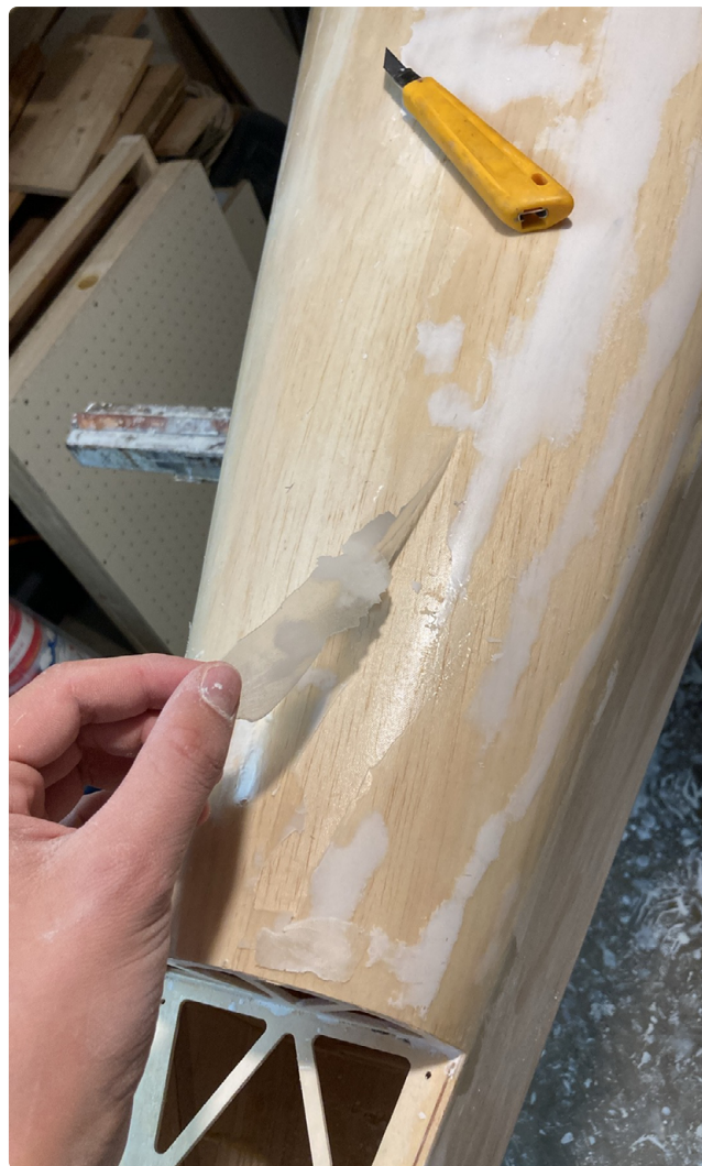
Ryc. 16. Laminowanie kadłuba tkaniną szklaną przesyconą żywicą epoksydową
