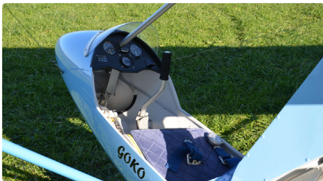
Ryc. 3. Kabina, siedzisko wyposażone w pięciopunktowe pasy pilota
