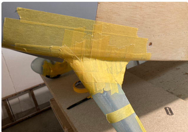
Ryc. 22. Wykonanie opprofilowania przejścia między rękawem goleni podwozia a kadłubem
