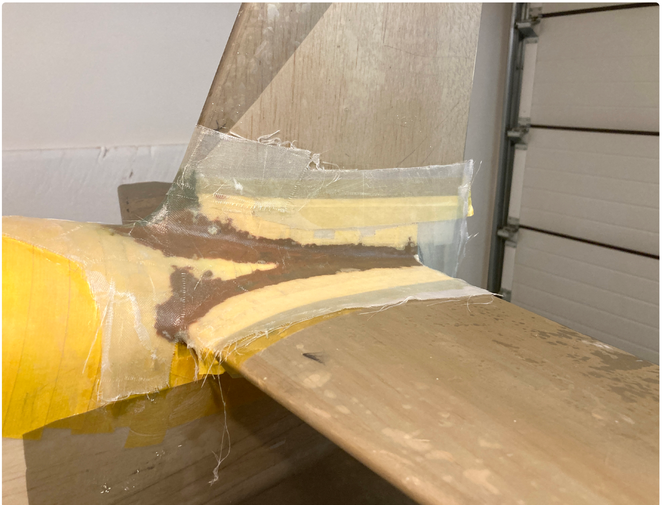
Ryc. 19. Wykonanie oprofilowania przejścia między sterem wysokości i kierunku
