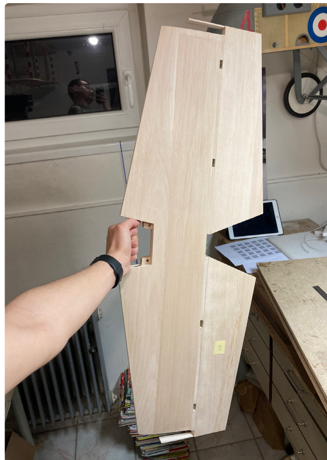
Ryc. 8. Kompletne usterzenie poziome przed wykończeniem
