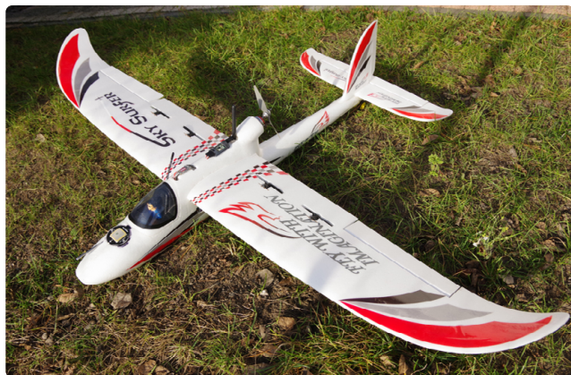
Ryc. 11. Model motoszybowca zbudowany do testowania układu napędowego PROPWING [5]
