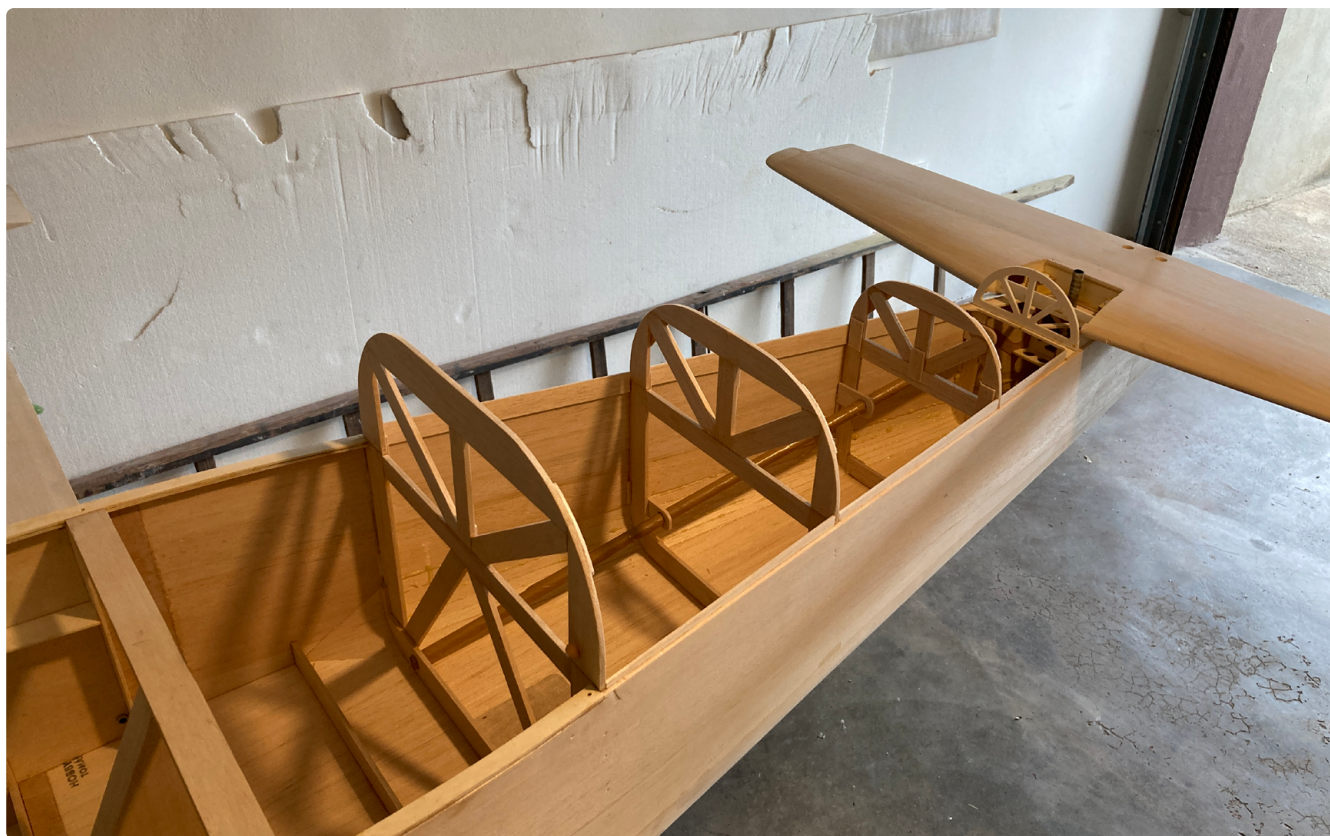
Ryc. 12. Konstrukcja tylnej części kadłuba
