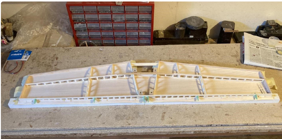
Ryc. 7. Konstrukcja wewnętrzna statecznika poziomego jak w oryginale
