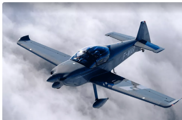
Ryc. 11. Samolot Integral R, w którym wykorzystano drewno jako materiał konstrukcyjny
