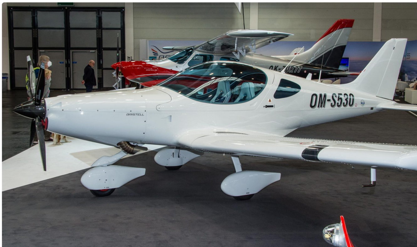
Ryc. 5. Bristell XL8 z napędem na silnik turbośmigłowy z regeneracją ciepła
