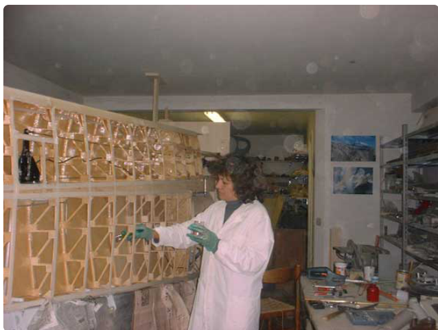
Ryc. 7. Nakładanie warstwy ochronnej żywicy epoksydowej na powierzchnie wewnętrzne konstrukcji skrzydła
