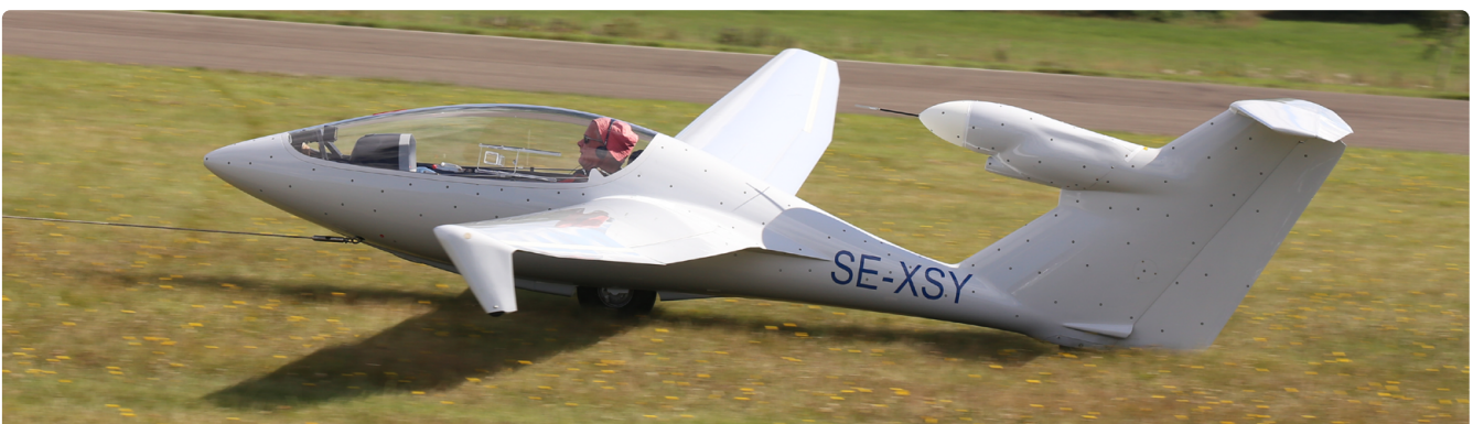
Ryc. 5. Oblot motoszybowca Windex po zdemontowaniu układu napędowego. Holowanie do startu za samolotem Piper Pawnee
