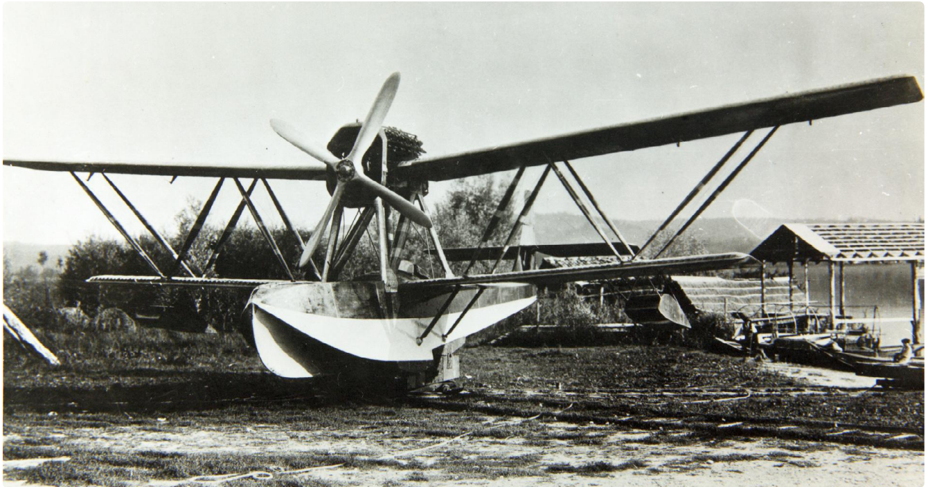
Ryc. 10. Łódź latająca Macchi M.19. Dobrze widoczne ustawienie zastrzałów w kratownicę Warrena. Widać też silnie wklęsły kształt dennicy w części dziobowej kadłuba oraz czterołopatowe śmigło
