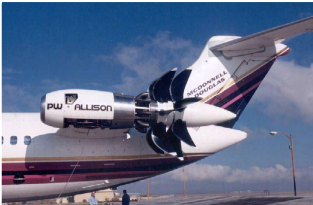
Ryc. 3. Silnik PW-Allison 578-DX podczas testów na samolocie MD-80 (źródło: [8])
